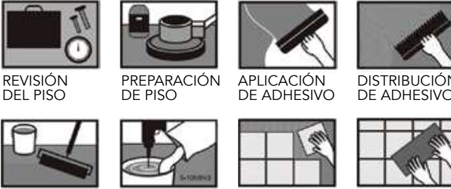
REVISIÓN DEL PISO PREPARACIÓN DE PISO APLICACIÓN DE ADHESIVO DISTRIBUCIÓN DE ADHESIVO APLICACIÓN DE PRIMER PREPARACIÓN DE ADHESIVO INSTALACIÓN DE PISO APLICACIÓN DE PRESIÓN
